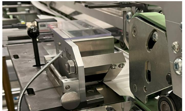
La Side Seam Gluing Unit est facile à installer sur les machines existantes.
